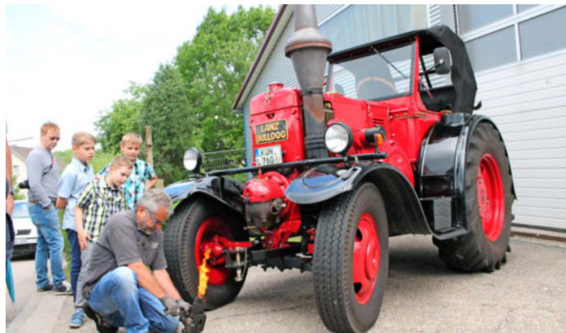
Der Nachwuchs guckt Theo Schmutz über die Schulter, als er die Glühlampe für den Lanz Bulldog auf Temperatur bringt.
